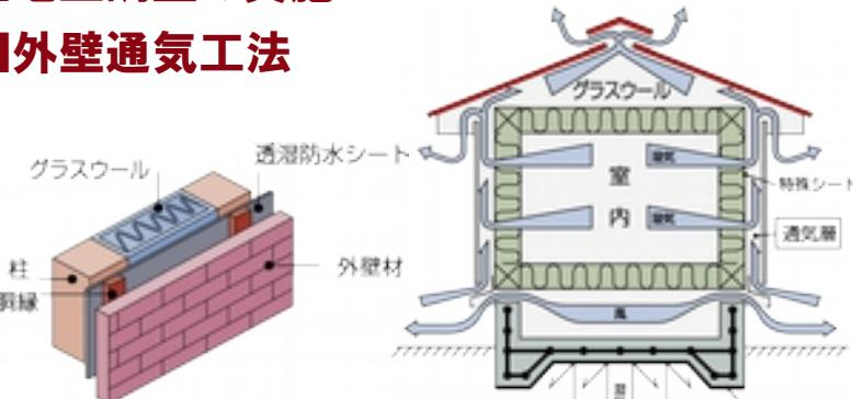
外壁材と構造躯体(柱)との間に通気層を設けています。結露を防ぎ、建物の劣化を軽減、気密性を維持しながら、壁体内の湿気をスムーズに外へ排出します。透湿性に優れた透湿防水シートを通気層内に施しています。
